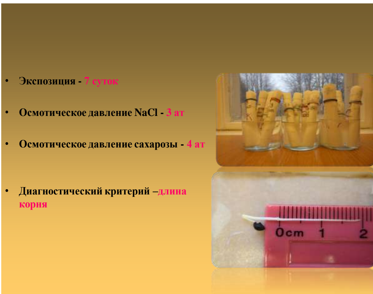
Рисунок 7. Рулонный метод оценки образцов лука на соле- и засухоустойчивость
